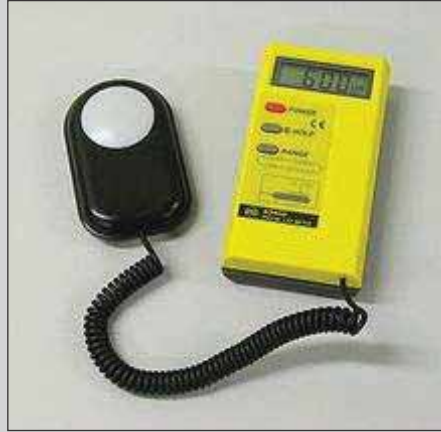
Люксометр для измерения освещенности на рабочих местах
